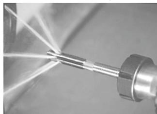
Подача СОЖ в развёртках для глухих отверстий происходит через несколько отверстий в каждой канавке расположенных в шахматном порядке за режущими кромками под углом к оси что позволяет выбрасывать стружку из отверстия вперёд.
